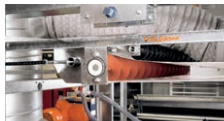
Inversión cinta de estiércol con espiral de limpieza (opcional), limpia la cinta de polvo y plumas durante el retorno
