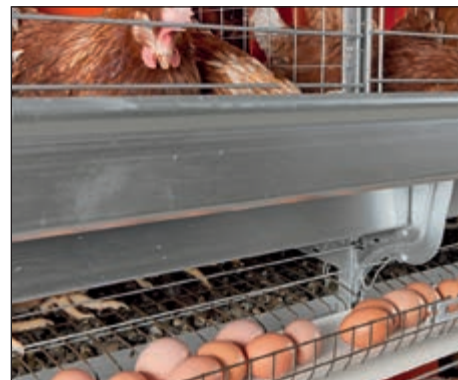
EggSaver felemelt helyzetben → az út a tojások számára szabad a hosszanti tojásszalaghoz
