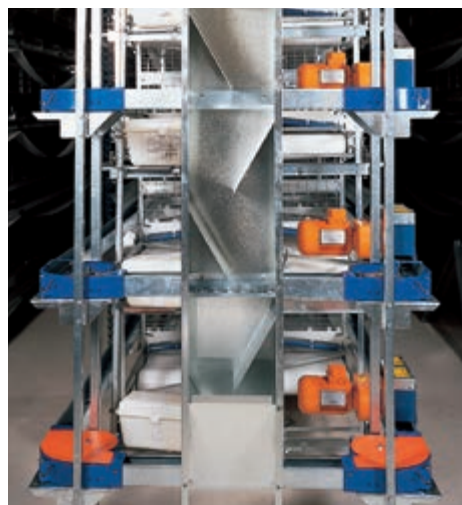
Каскадная форма кормоколонки предотвращает склеивание корма
