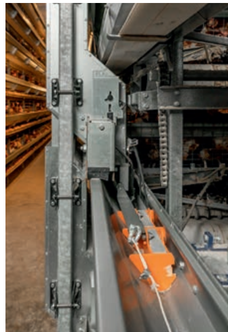
Кормовая заслонка на участке конечного узла
