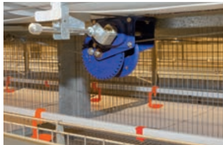
Suluk hattının yüksekliğini ayarlamak için merkezi olarak monte edilmiş vinç
