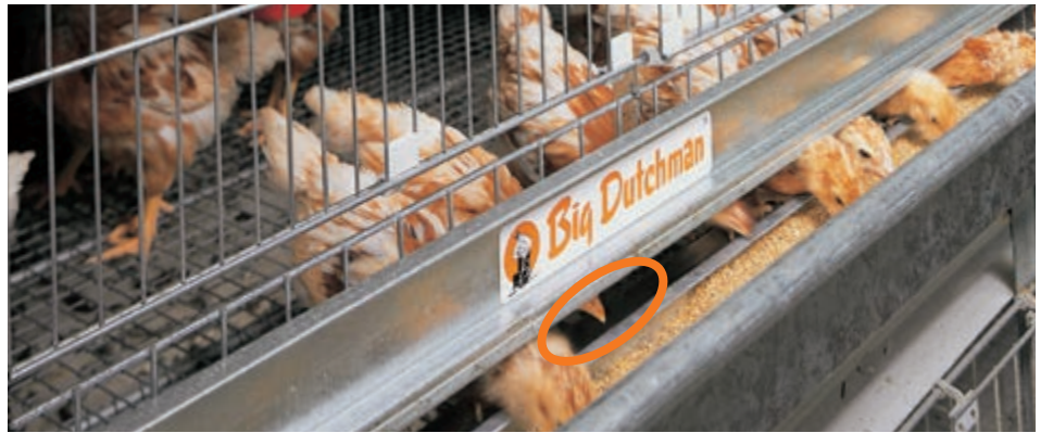
Yem israfından kaçınmak için kesintisiz yem penceresi ve içe dönük oluğa sahip başlangıç katı
