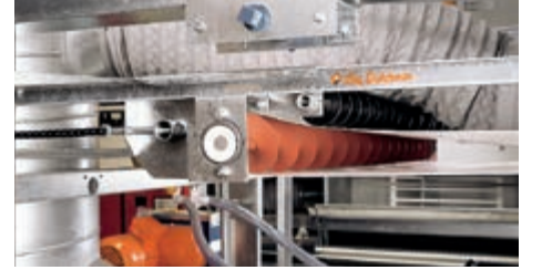
Gübre bandı taşıyıcı makarası, temizleme burgusu (opsiyonel) ile geri gelen banttaki toz ve tüyleri temizler
