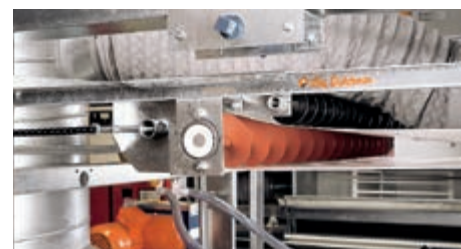
Поворотний вузол стрічки видалення посліду з очисним шнеком (опція) для очищення стрічки ВП від пір'я і пилу (при поверненні стрічки)
